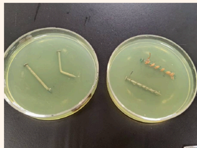
左：彎曲和直鐵釘生鏽情況 右：銅線和鋅條鐵定生鏽情況
